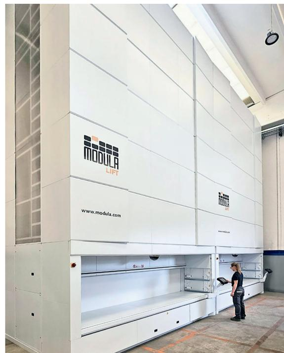
Di recente l'azienda ha ampliato il suo hub logistico aggiungendo 1.200 mq di spazio magazzino e installando due nuovi armadi verticali MODULA, ciascuno con 51 cassette che hanno ognuno una capacità di stoccaggio di 500 kg.
